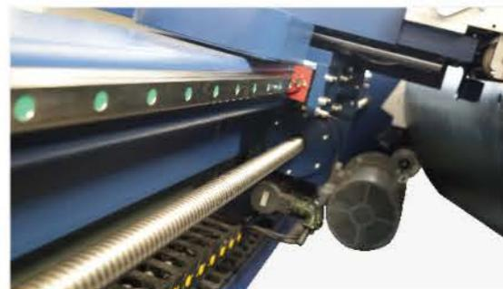
▲ 导轨排布：二条高精度直线导轨，分布在挡板内外两侧面
