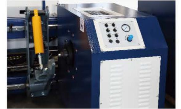
▲ 拍开拍合：齿轮箱左右移动实现拍开拍合
