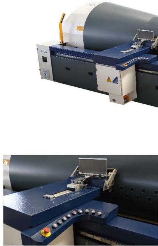
▲ 整经台：导纱辊无需打开，便可放入绞线，经纱排列得到完整保持。平整辊可以保持纱线层的平整度。
