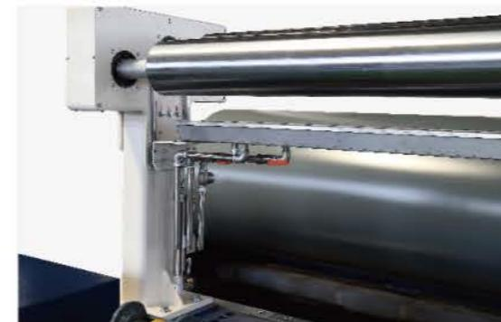
▲ 上油上蜡装置：倒轴时可采用多种穿纱方式，减少了中间过渡罗拉的摩擦。
