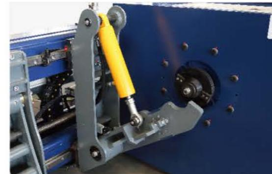
▲ 上下轴装置：通过液压动力单元驱动经轴上下轴，额定负载高达 4000KG
