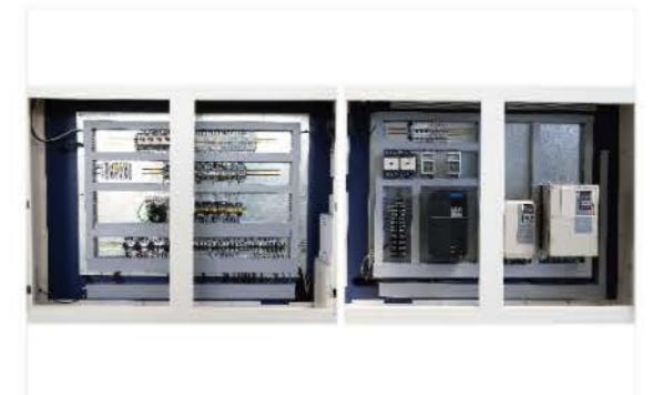
▲ 倒轴电气控制系统
