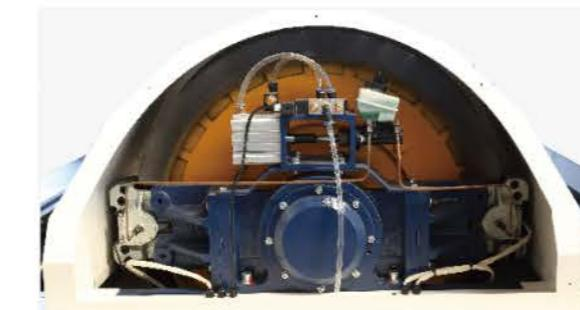
▲ 制动系统：采用液压盘式制动器，制动快速平稳
